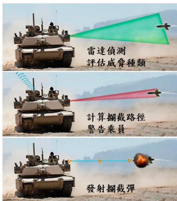
圖六：戰車主動防禦系統作動原理[36]
