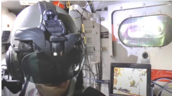
圖九：「鐵視」(IronVision)頭戴式顯示器及影像顯示[43]
