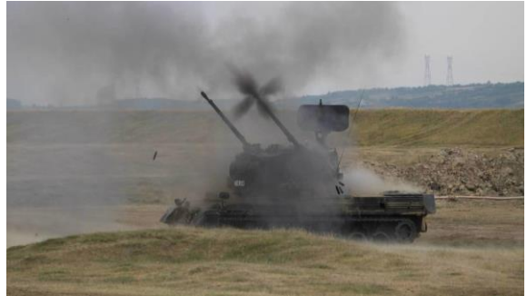
圖十一：獵豹防空戰車（每分鐘射速 550 發，最大射高 4000 公尺）[58]
