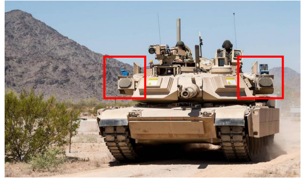
圖五：美 M1 戰車加裝「戰利品」主動防禦系統[22]
